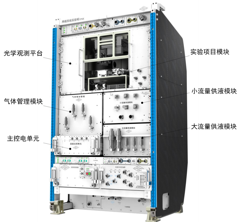
图 5.6 两相系统实验柜的系统组成图
