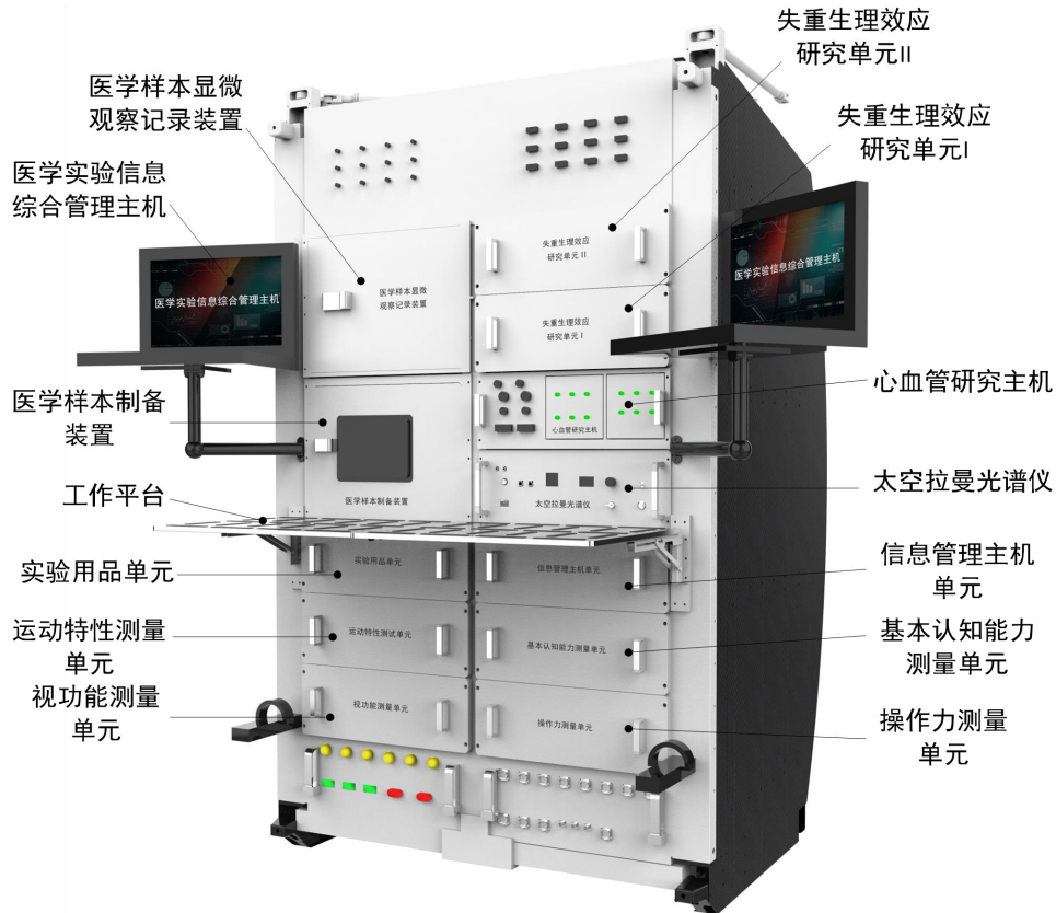
图 5.1 人系统研究机柜的系统组成图
