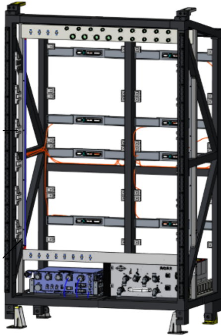
图 5.20 机柜装载空间支撑结构组成
